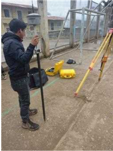
Imagen 01. Instalación de la base
